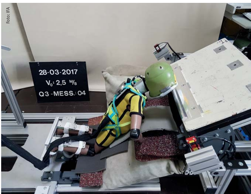
Abbildung 3: Versuchseinrichtung mit Kinder-Dummy beim Aufprall auf Kante
