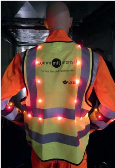
Abbildung 2: Versuchsaufbau: Warnweste mit applizierten LED
