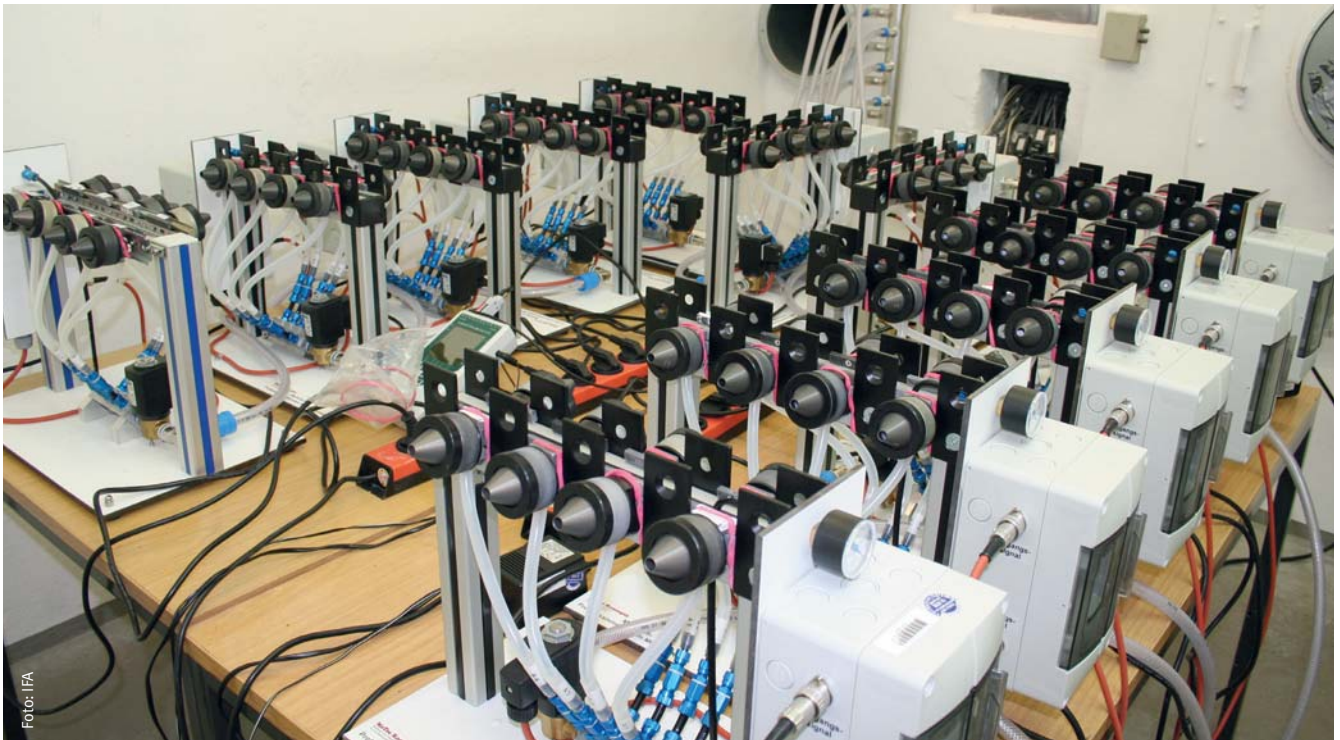
Aufbau für die simultane Beaufschlagung von Filterproben mit metallhaltigen Stäuben
