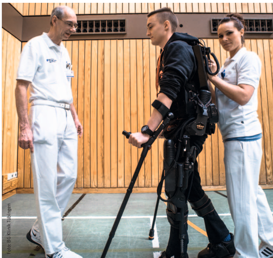
Gehtraining mit dem computergesteuerten Exoskelett
