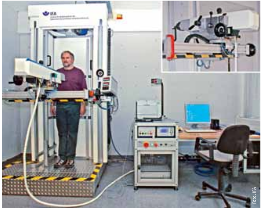
Algometer zur Bestimmung von Druckschmerzschwellen
