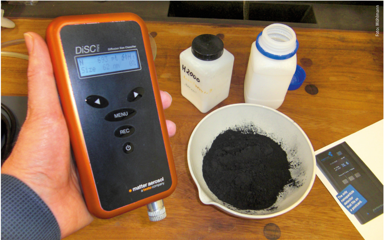
Kompakte Messgeräte erleichtern die Messung von Nanoobjekten am Arbeitsplatz (im Bild: DiSCmini Particle Counter von Matter Aerosol)
