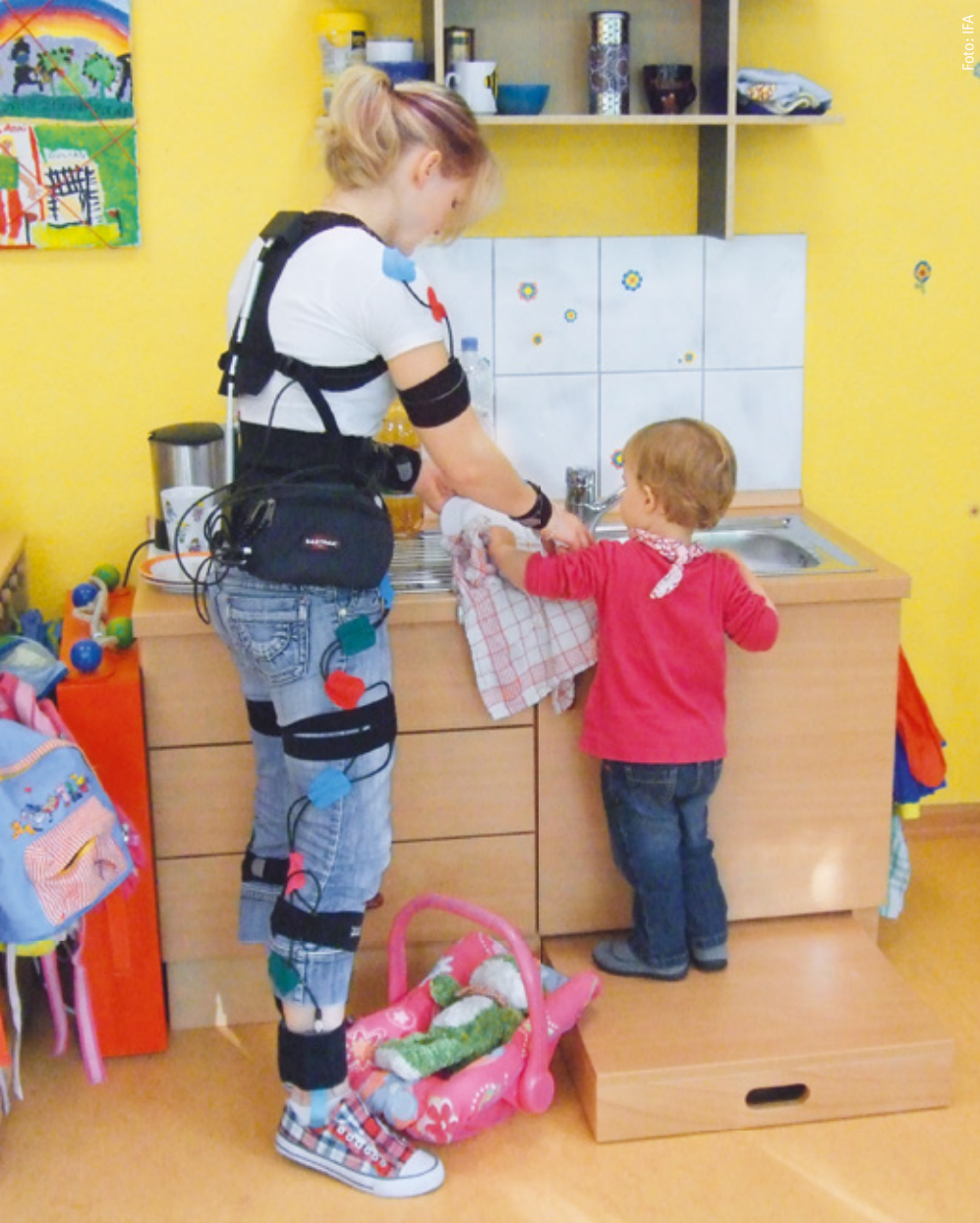
Abbildung 1: Präventionsprojekt ErgoKiTa zur Prävention von Muskel-Skelett-Belastungen bei Erzieherinnen in Kindertageseinrichtungen: Messtechnische Erfassung physischer Belastungen im KiTa-Alltag mit dem CUELA-Messsystem.
