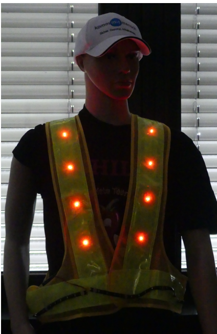
Abbildung 1: Geschirr mit aktiver Beleuchtung (einzelne LEDs)
