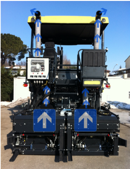
Abbildung 3: Im Ausland werden bereits seit längerem Straßenfertiger eingesetzt, die mit einer Absaugung für die Dämpfe und Aerosole ausgestattet sind
