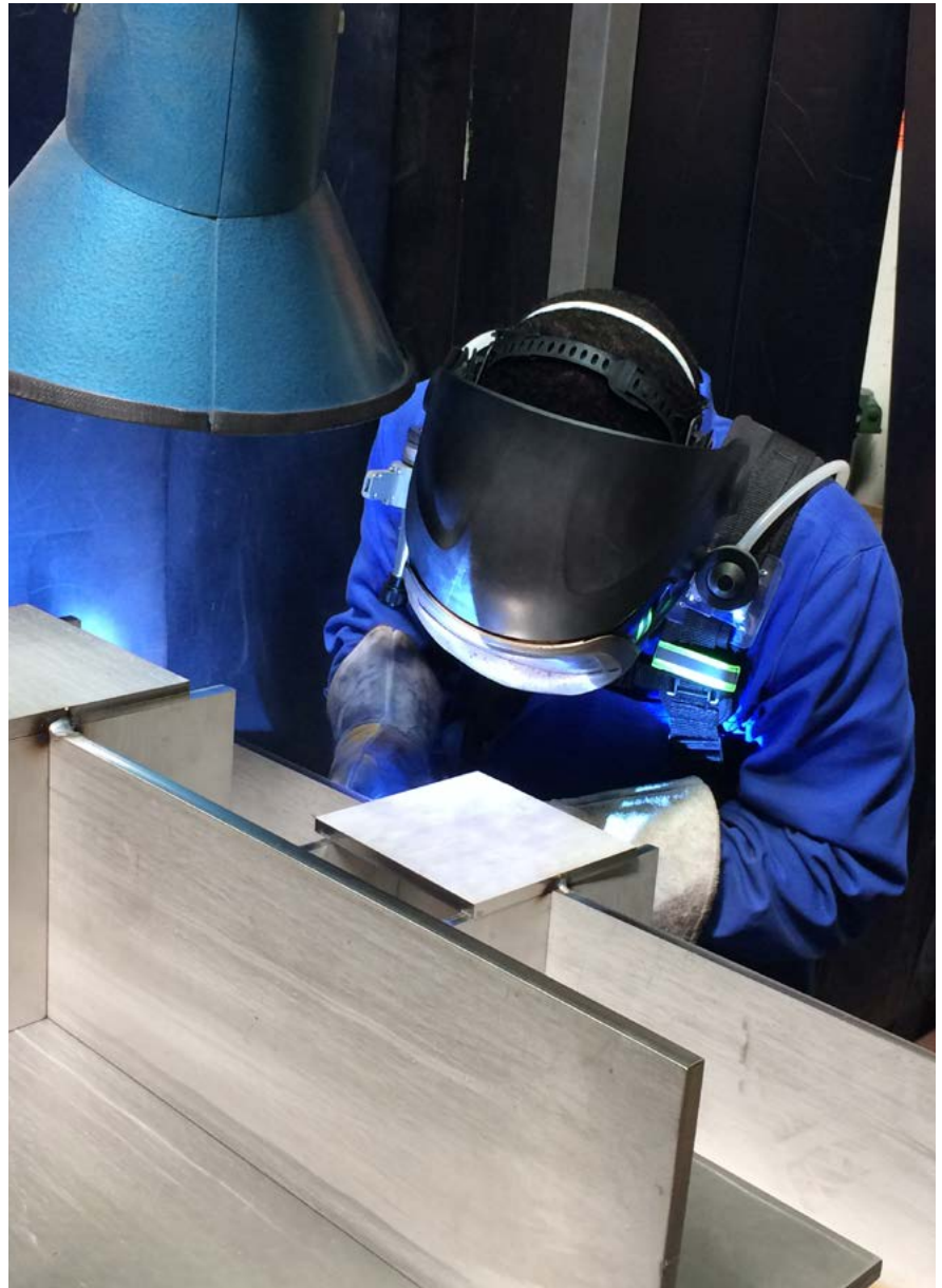
Emissionsarmes MAG-Schweißen mit modifiziertem Impulslichtbogen von zehn Millimeter starken Chromnickelstahlblechen
