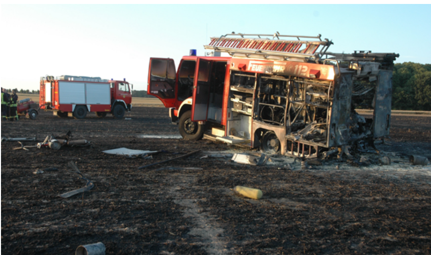
Abbildung 3: Bei einem Flächenbrand zerstörtes Löschfahrzeug [4]
